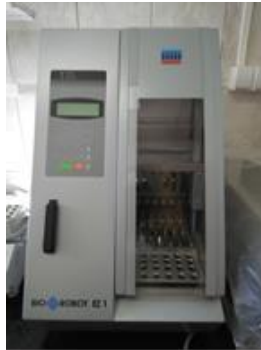
BioRobot EZ1 (Qiagen, Hilden, Germany) за изоловање ДНК
