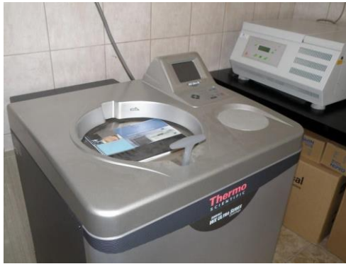
Ултрацентрифуга SORWALL WX 80
