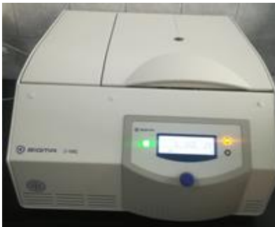
Центрифуга (SIGMA 2-16KL), центрифугирање материјала и добијање цитогенетичких микроскопских препарата
