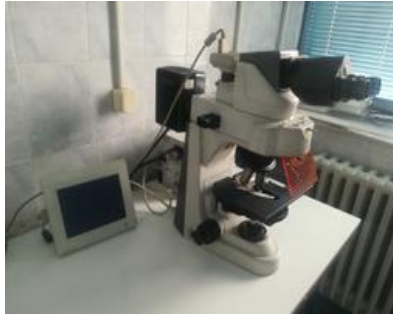
Истраживачки микроскоп (Nikon, Eclipse 50i) са додатком за анализирање флуоресцентно обојених микроскопских препарата, анализа цитогенетичких микроскопских препарата
