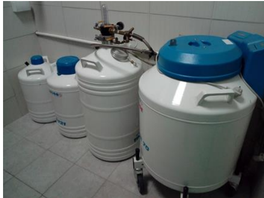
Аутоматски биогенетски танкови за чување узорака (капацитет 2000 узорака)
