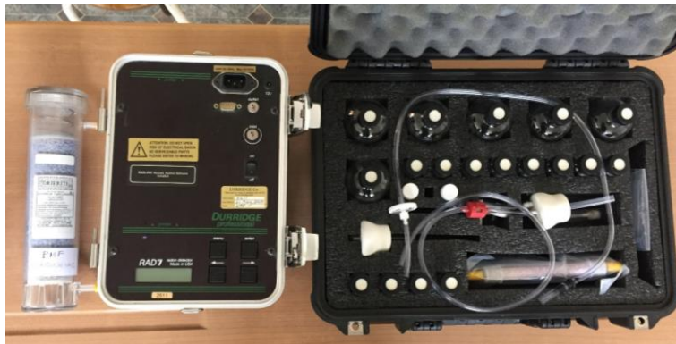
Уређај RAD7 (Durridge Company Inc.) за активно мерење концентрације радона и RAD H2O наставак
