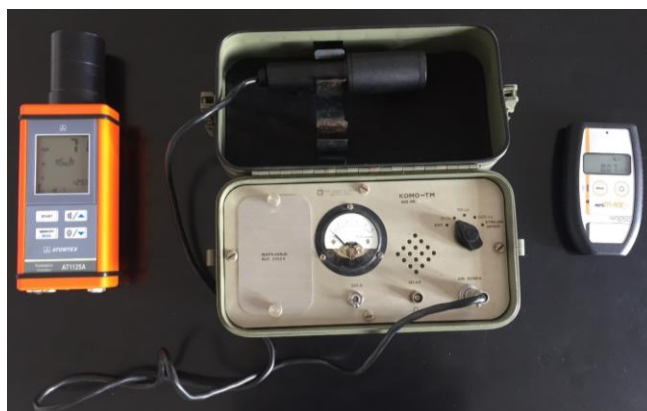
Активни уређаји за мерење X и гама зрачења: Atomtex (AT1125), KOMO-TM и MiniTRACE
