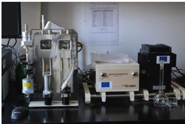
Applied Photophysics Stopped flow за спектрофотometriјско праћење брзих хемијских реакција
